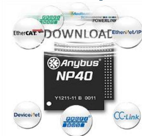
Anybus® CompactCom™ C40 - это высокопроизводительное сетевое коммуникационное решение в формате чипа. Он состоит из сетевого процессора Anybus NP40, загруженного программным обеспечением, необходимым для подключения промышленного устройства к другой сети fieldbus или промышленной сети Ethernet.
