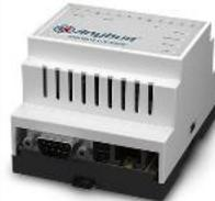
С помощью шлюза Anybus Modbus вы можете подключать устройства Modbus RTU к сетям Modbus-TCP. Шлюз работает как транслятор (маршрутизатор) между двумя сетями, позволяя подключить до 32 устройств Modbus RTU к сети Modbus-TCP.
