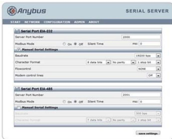
Сначала необходимо установить лицензионное программное обеспечение Serial / IP. Программное обеспечение можно загрузить и номер лицензии, которую вы получите от HMS. Отсюда легко выполнить настройку через встроенный веб-сервер. Просто запустите веб-браузер и введите IP-адрес шлюза (вы можете установить IP-адрес по своему выбору с помощью программного обеспечения Anybus IPConfig, которое можно бесплатно загрузить в разделе файлов и документации).
