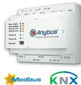
Шлюз Anybus Modbus-KNX позволяет подчиненным устройствам Modbus взаимодействовать в сети KNX. Шлюз работает как транслятор между двумя сетями, позволяя считывать и контролировать сигналы Modbus RTU и Modbus TCP из любой сети KNX TP1. Это позволяет централизованно контролировать и контролировать устройства Modbus из системы KNX в здании.
