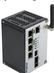
Anybus Edge Gateway PROFIBUS с коммутатором может подключать устройства PROFIBUS, Modbus TCP или Modbus RTU к HMS Hub, а также может выступать в качестве сервера OPC UA или клиента MQTT. Шлюз также обеспечивает сотовую беспроводную связь.
