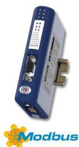
Интегрируйте свои промышленные устройства и оборудование на базе CAN в систему управления Modbus RTU без каких-либо изменений в устройстве. Просто подключитесь, настройте и все готово!
