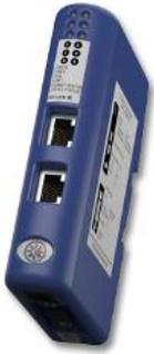
Anybus Communicator - это проверенный и надежный шлюз конвертера протоколов, который соединяет не сетевые промышленные устройства и оборудование с полем CC-Link IE. Шлюз выполняет интеллектуальное преобразование протокола и представляет последовательные данные в главный ПЛК / контроллер как легко обрабатываемые данные ввода / вывода.
