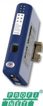
Интегрируйте свои серийные промышленные устройства и оборудование на основе RS-232/422/485 в систему управления PROFINET без каких-либо изменений в устройстве. Просто подключитесь, настройте и все готово!
